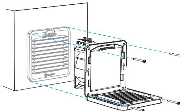
El montaje solo con los clips es óptimo para chapas con un espesor de 1.5 mm; puede utilizarse con espesores de 1 a 2.5 mm. Se aconseja la fijación con tornillos (adjuntos). Par de apriete 0.3 Nm.
